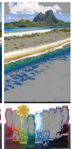
図-15 Adobe Photoshop にて「色域外警告」時の表示 グレーの部分が色域外であることを示している。CMYK プロファイルを使用。
