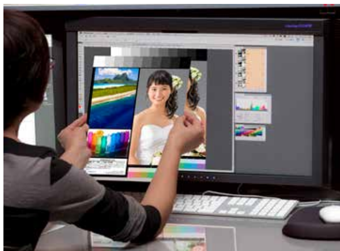
図 -9 モニタと印刷物におけるグレイチャートの比較方法
